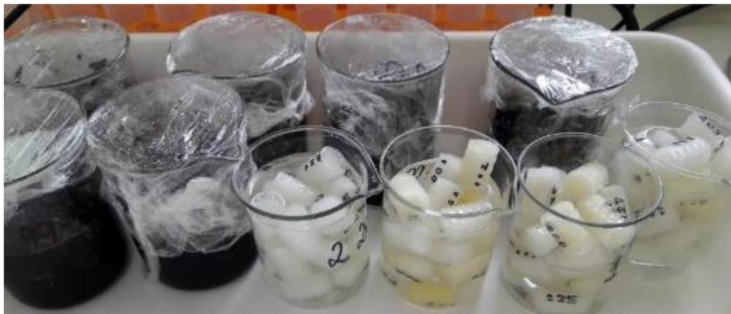
A inoculação foi realizada do fundo para o topo de cada um dos três compartimentos, inserindo-se primeiramente os 40 mini-BioBobs® saturados com o efluente sintético e, em seguida os outros 60 contendo o lodo. Ao final da inoculação, o lodo (formado principalmente de grânulos) que não se aderiram à espuma foram adicionados à parte superior do compartimento correspondente. Esse procedimento levou a algumas dificuldades operacionais, que serão melhor discutidos no tópico 5.4.5.2.
