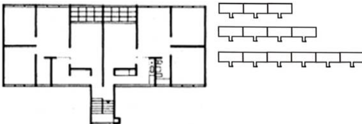
Figura 10: Planta baixa da tipologia habitacional existente no bloco de quatro pavimentos da Vila Guiomar.
