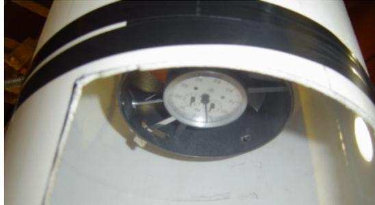
Foto 6.2 Anemômetro instalado na tubulação da campânula.
