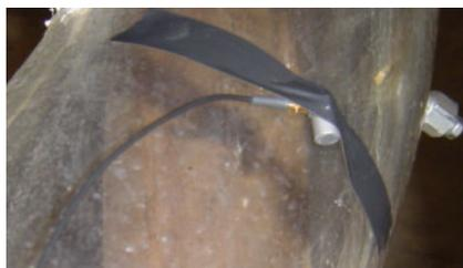
Foto 6.6 Acelerômetro instalado na curva.
