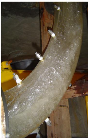
Foto 7.5 Escoamento na curva C4 para  $Q/Q_0 = 0,6$ .
