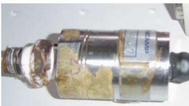
Foto 6.4 Transdutor utilizado para a medição de pressões.
