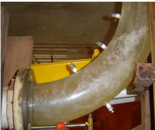
Foto 7.4 Escoamento na curva C2 para  $Q/Q_0 = 0,8$ .
