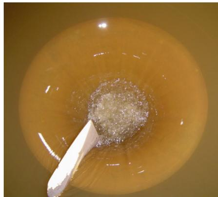
Foto 7.1 Formação do “boil” na tulipa, com a curva C3, para a vazão de 1150  $m^3/s$ , em valores de protótipo.
