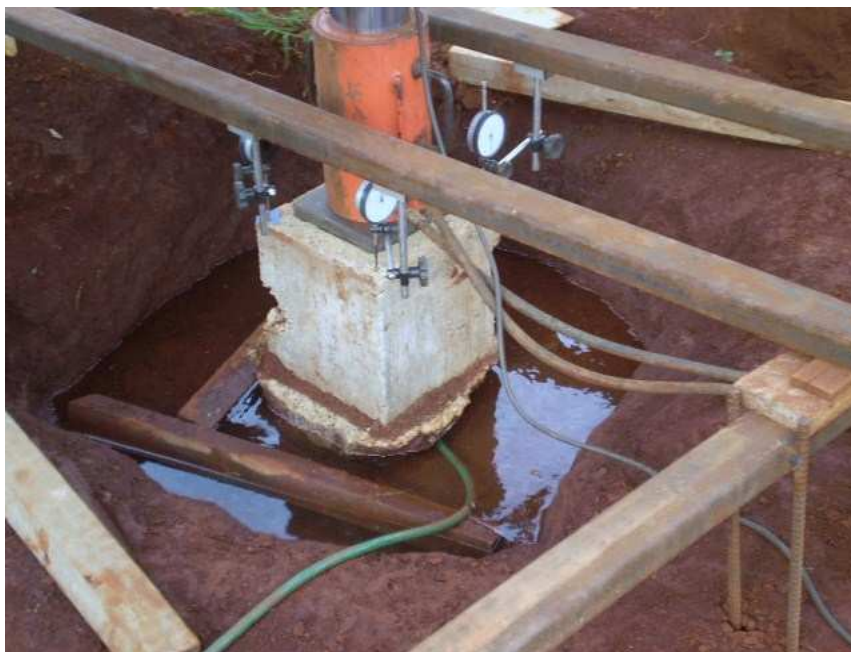
Figura 4.8. Prova de carga com pré-inundação.
