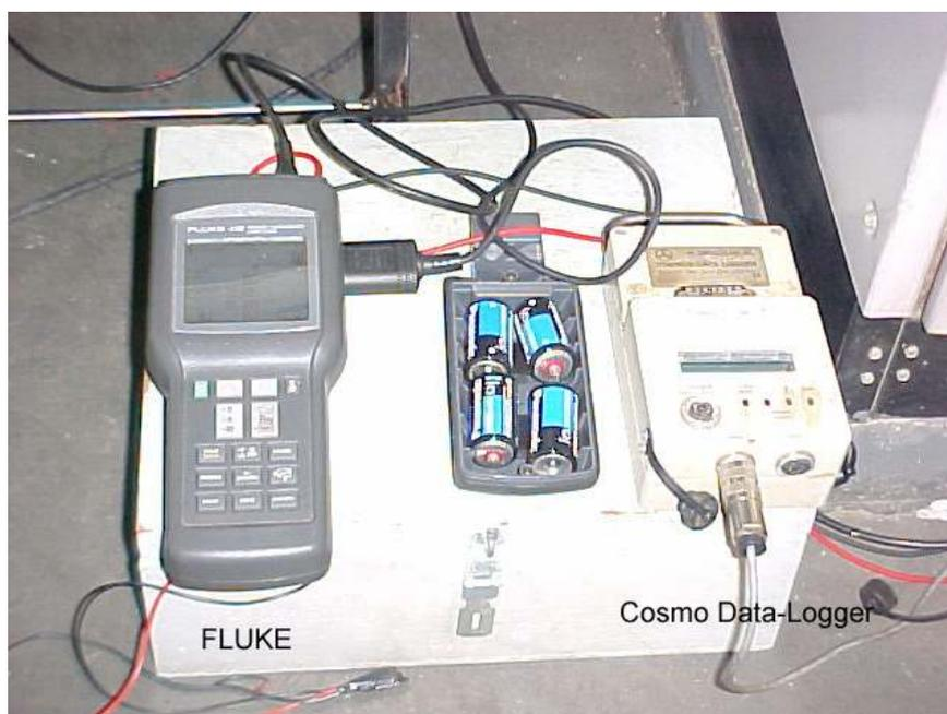
Figura 4.4 – Instalação dos equipamentos de aquisição de dados
