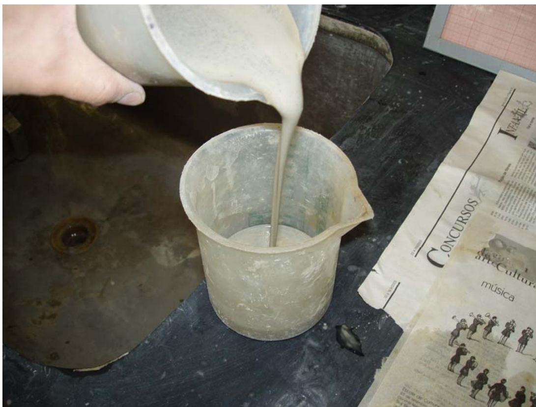
Figura 5.2. Aparência da pasta logo após a realização do procedimento de mistura.
