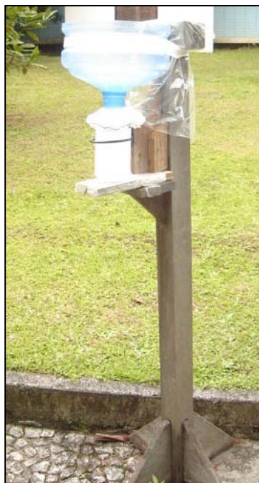
FIGURA 4.5 Foto do coletor utilizado para coleta das amostras provenientes de deposição seca e úmida, mostrando suporte em madeira, frasco plástico e funil de PET.
