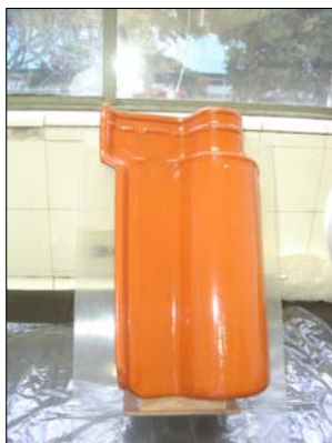
FIGURA 4.4 Suporte utilizado para apoiar as telhas durante a lavagem das mesmas com chuva sintética.
