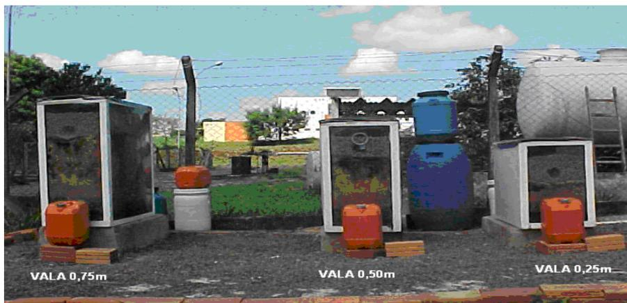
Figura 4.6 Valas de filtração e suas respectivas alturas 0,75; 0,50 e 0,25 m de areia.
