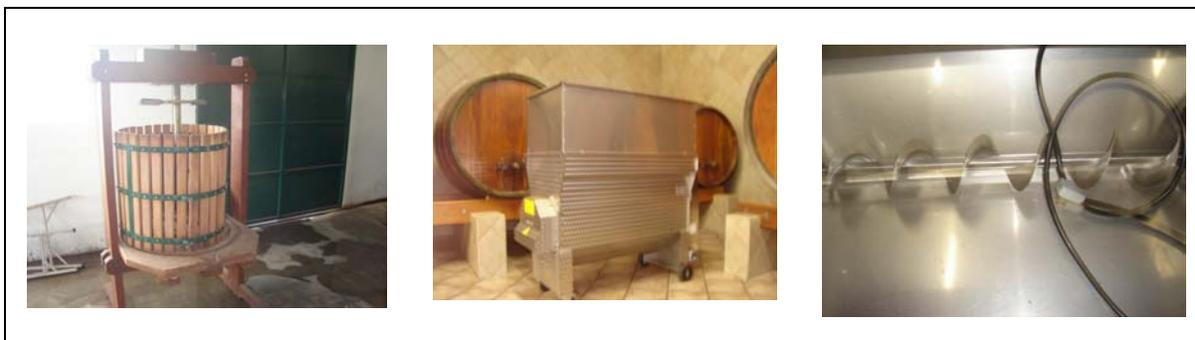
Figura. 5.21. À esquerda, uma prensa manual de madeira utilizada na etapa de esmagamento; no centro e à direita, fotos de uma máquina para desengace e esmagamento, italiana, de aço inox, utilizada no Sítio Nossa Senhora do Carmo em Jundiáí.
