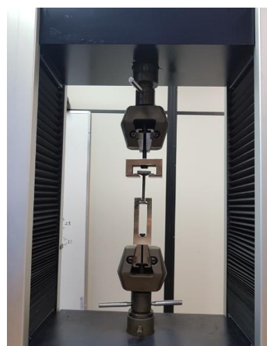
Ensaio à tração da armadura de cisalhamento
