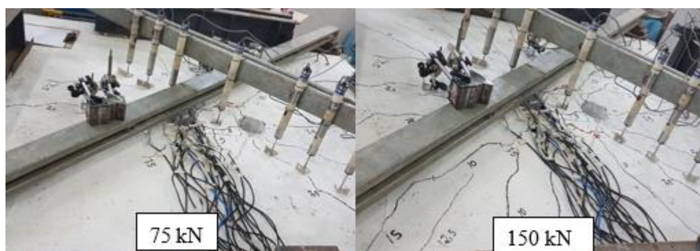
Figura 4.72 - Desenvolvimento das fissuras da laje L2-100-8s
