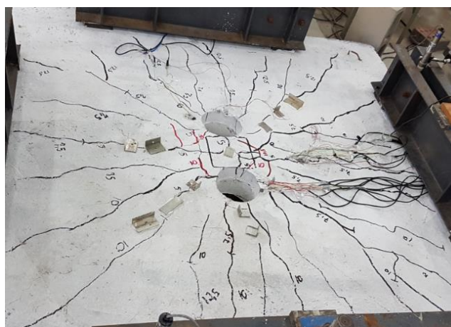
Figura 4.35 - Laje L2-150-6s após a ruptura.
