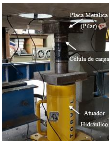
Figura 3.26 - Equipamentos para aplicação do carregamento.
