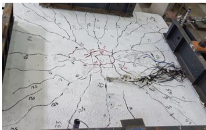
Figura 4.23 – Laje LR-8s pós ruptura.
