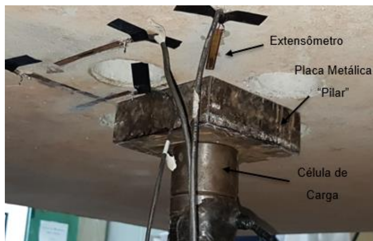
Figura 3.25 - Fotografia dos extensômetros de concreto na laje L4-75.
