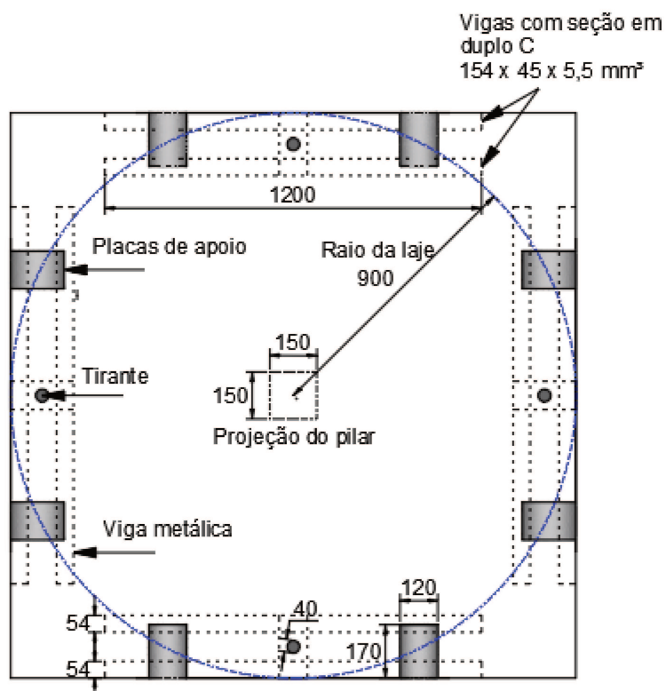
Figura 3.4 – Vista superior da laje. Dimensões em mm.
