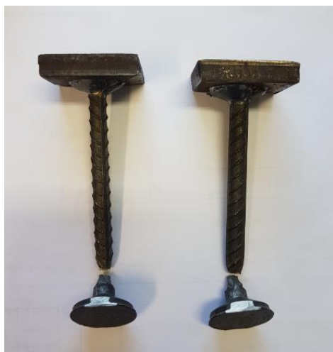
Armadura de cisalhamento pós ruptura do ensaio a tração
