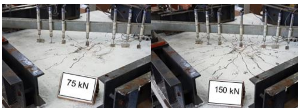
Figura 4.66: Desenvolvimento das fissuras da laje LR.
