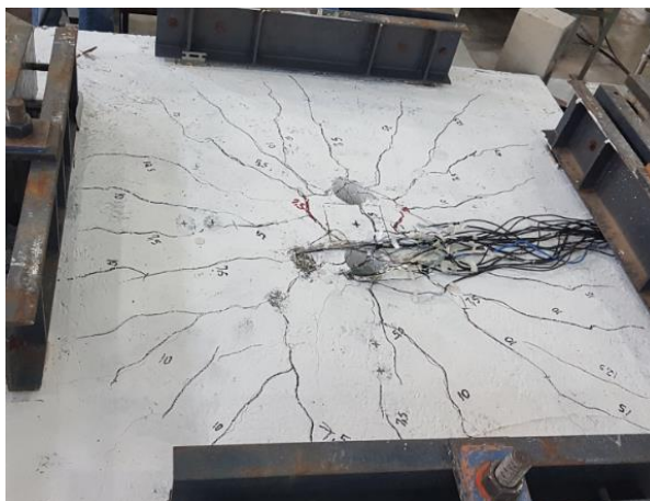
Figura 4.41 - Laje L2-100-8s pós ruptura.
