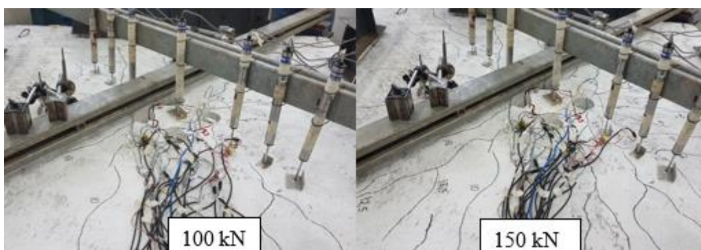
Figura 4.73 - Desenvolvimento das fissuras da laje L4-75-8s
