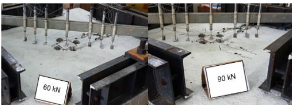
Figura 4.68: Desenvolvimento das fissuras da laje L4-75.
