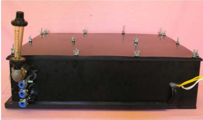
**Figura 6:** Reator fotocatalítico
