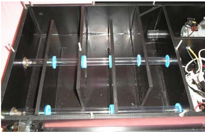
**Figura 7:** Interior do reator fotocatalítico sem lâminas de filme PPC impregnadas com  $\text{TiO}_2$ .
