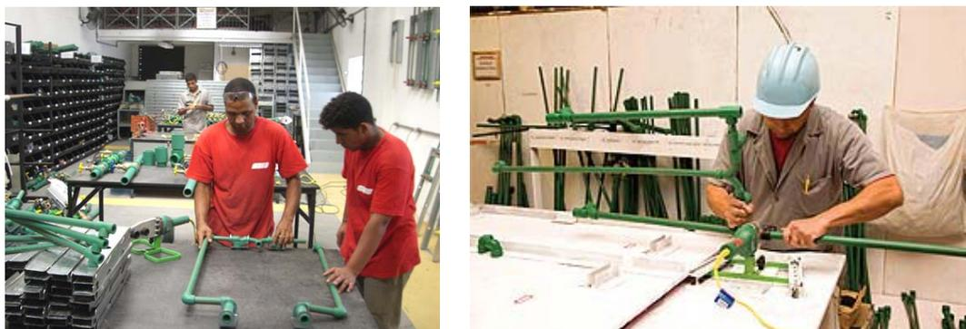
Figura 2.8 – Pré-montagem de *kits* hidráulicos como prevenção a patologias decorrentes da execução (Fonte: TÉCHNE, 2008)
