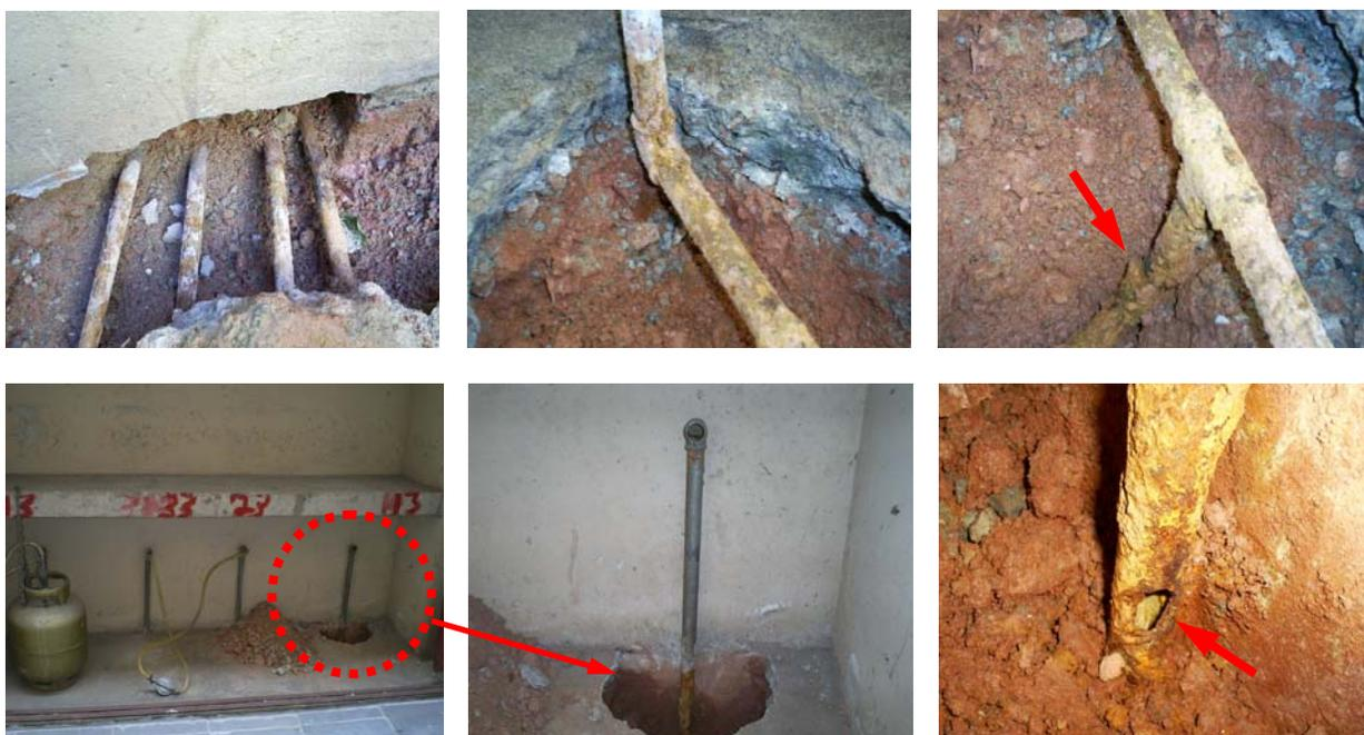
Figura 2.42 – Corrosão e vazamento de gás em tubulações de aço enterradas sem proteção superficial
