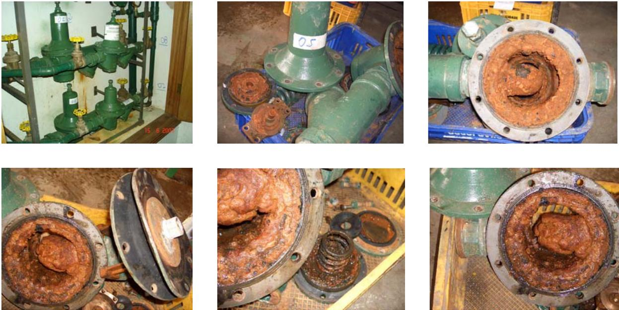
Figura 2.36 – Exemplo de vício redibitório: corrosão prematura de válvulas redutoras de pressão de ferro fundido instaladas em central redutora de pressão de água quente
