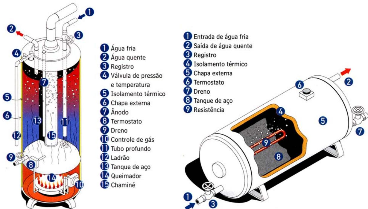
Figura 2.43 – Componentes de aquecedores de acumulação vertical (a gás – eq.) e horizontal (elétrico – dir.)
