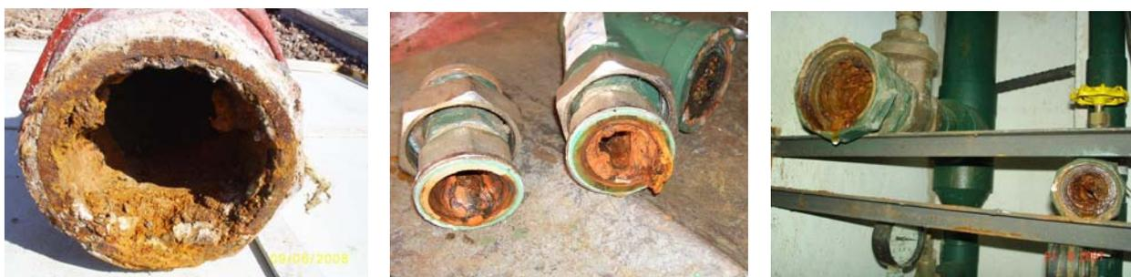
Figura 2.48 – Formação e aderência de biofilmes em incrustações de ferrugem em tubos e acessórios
