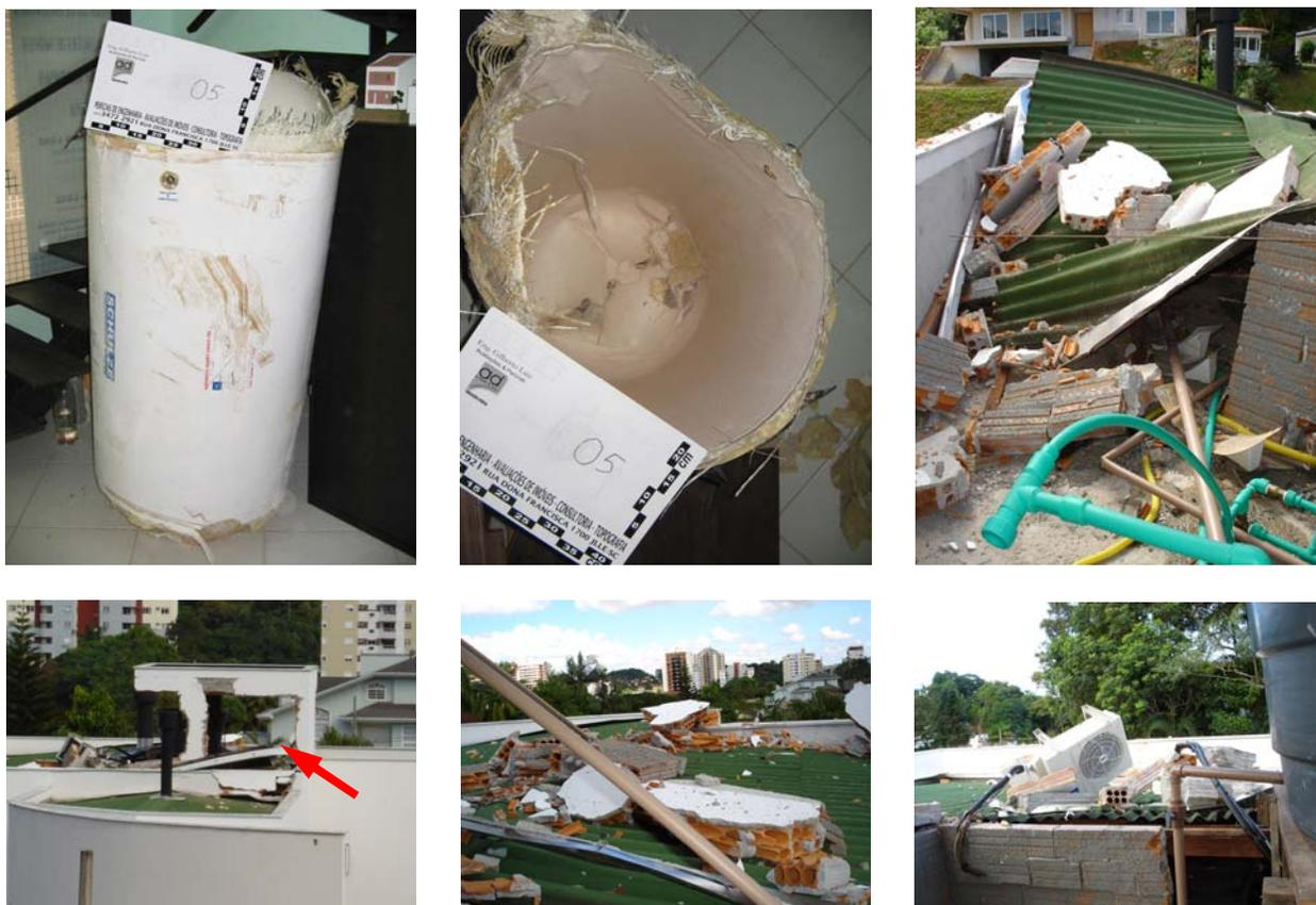
Figura 2.46 – Efeitos da explosão de aquecedor de acumulação de baixa pressão com tambor de fibra de vidro
