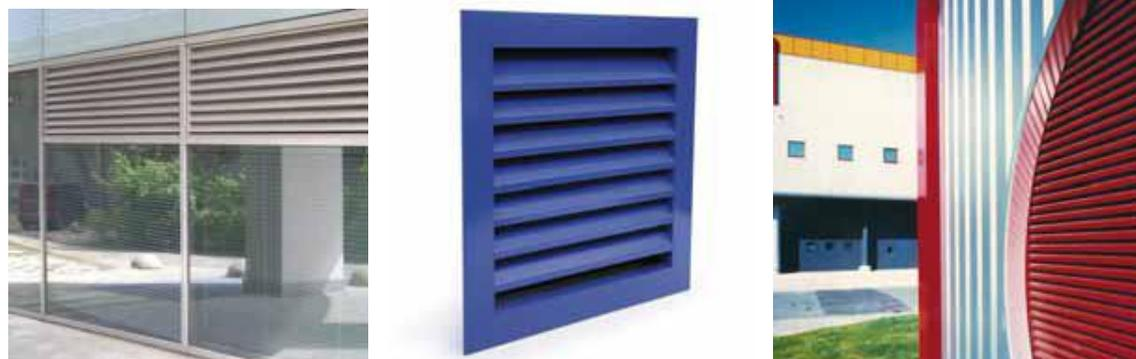
**Figura 4.31:** Tipologia : Renson 445/86 brises acústicos (grelhas) do fabricante “Renson”. Utilizados para agregar valores estéticos com redução de ruídos. Atenuação acústica com  $R_w$  de 6dB quando estão abertos. Fonte: [www.renson.be](http://www.renson.be).
