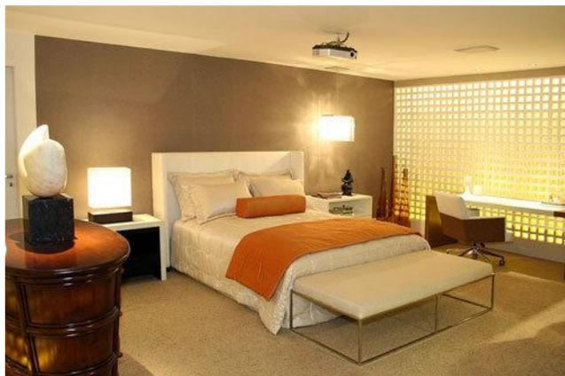
**Figura 2.25:** Exemplo de aplicação de cobogó.
