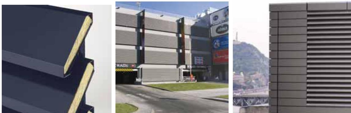
**Figura 4.34:** Tipologia : Renson L.060AC Acoustic Linius do fabricante “Renson” utilizados para agregar valores estéticos com redução de ruídos. Atenuação acústica com  $R_w$  de 6dB quando estão abertos. Fonte: [www.renson.be](http://www.renson.be).
