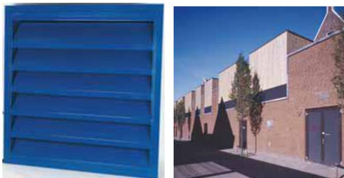
**Figura 4.32:** Tipologia : Renson 446/150 brises de paredes do fabricante “Renson”. Utilizados para agregar valores estéticos com redução de ruídos. Atenuação acústica com  $R_w$  de 11dB quando estão abertos. Fonte: [www.renson.be](http://www.renson.be).
