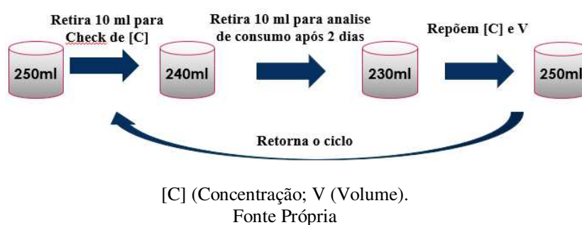
Figura 3. Esquema sistema RBS. Sendo [C] Concentração de substrato e V o volume em mL.
