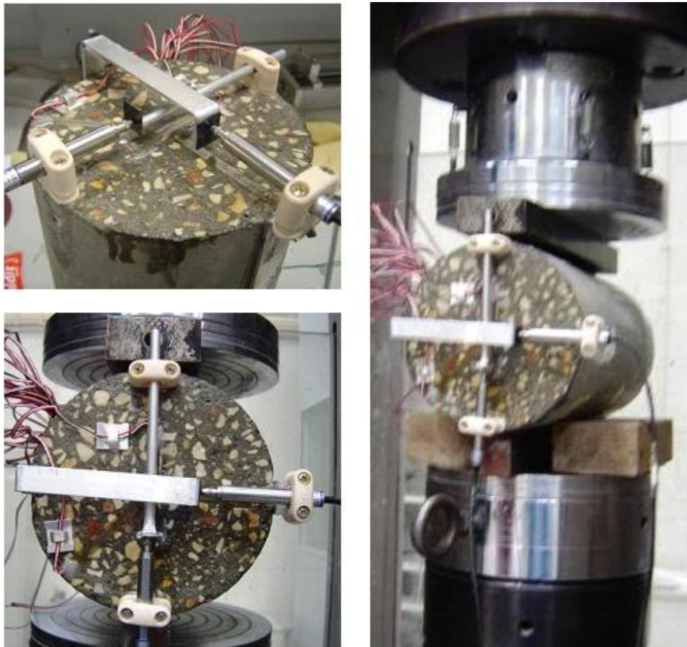
Figura 6.1 – Instrumentação e ensaio de compressão diametral.
