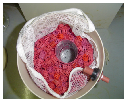
Figura 4.4 - à esquerda material utilizado para confecção dos cestos e cesto envolto com manta acrílica; ao centro introdução dos cestos na coluna de sustentação, à direita coluna vazia sustentando camada suporte e rede de poliéster envolvendo toda montagem.
