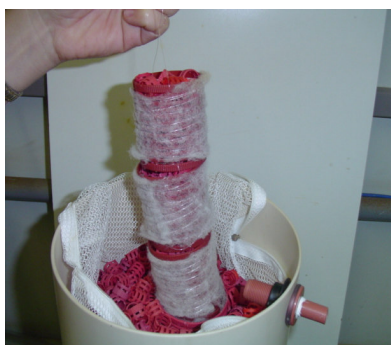
Figura 4.4 - à esquerda material utilizado para confecção dos cestos e cesto envolto com manta acrílica; ao centro introdução dos cestos na coluna de sustentação, à direita coluna vazia sustentando camada suporte e rede de poliéster envolvendo toda montagem.
