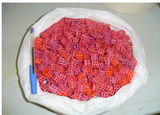
Figura 4.3 - Material plástico utilizado como meio suporte no FA e no BAS
