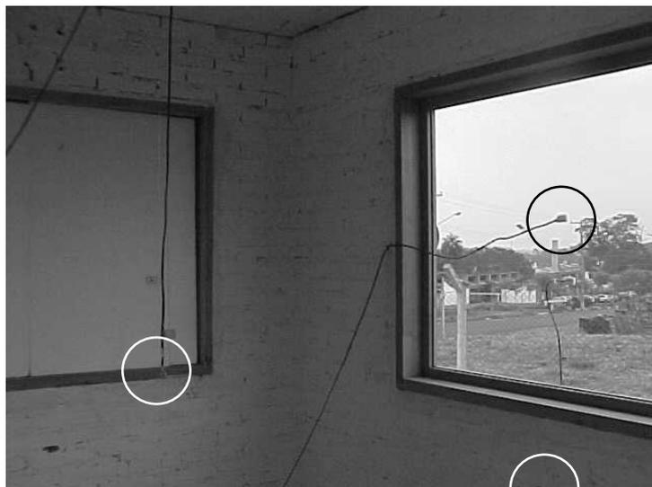
Fig. 4.66. Posicionamento dos sensores no ambiente interno, temperatura do ar e temperaturas superficiais internas do vidro e da parede.
