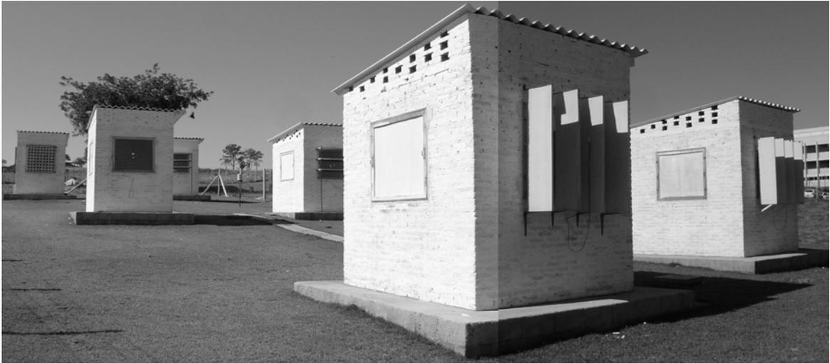
Fig. 4.59. Vista dos protótipos com os dispositivos de sombreamento em ensaio instalados na fachada oeste.
