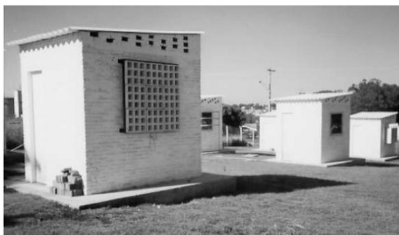
Fig. 4.58. Vista dos protótipos com os dispositivos de sombreamento em ensaio na fachada norte.
