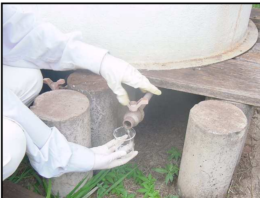
Figura 9 – Coleta de líquido percolado armazenado nos coletores de drenagem livre.
