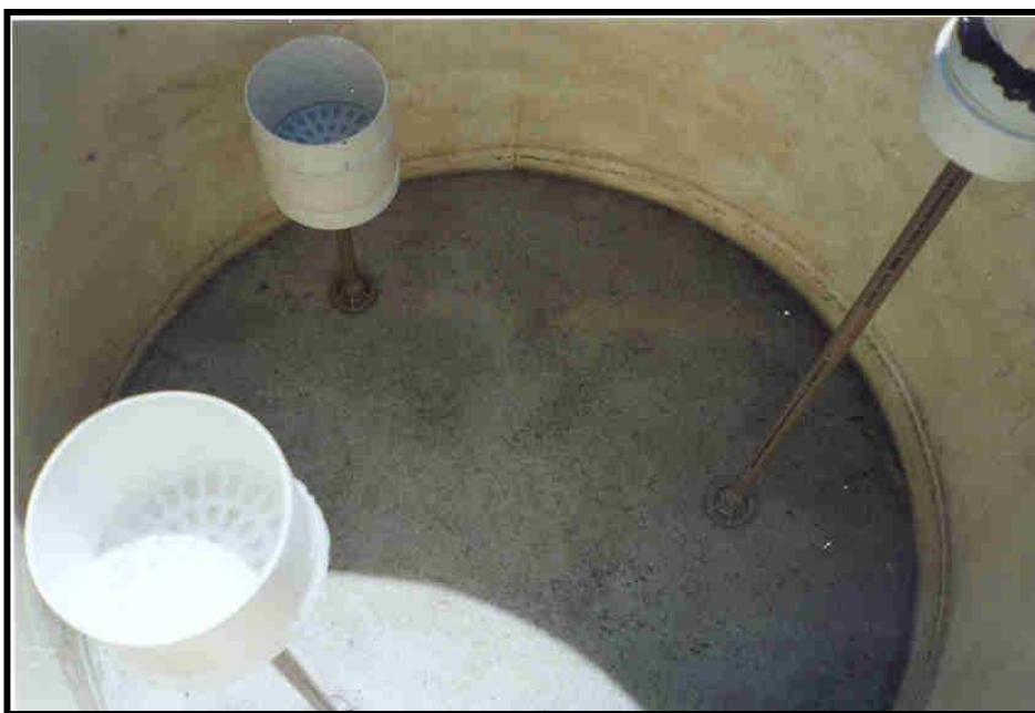
Figura 6 – Vista dos coletores de drenagem livre antes do preenchimento com solo. Fonte: NASCIMENTO (2002).
