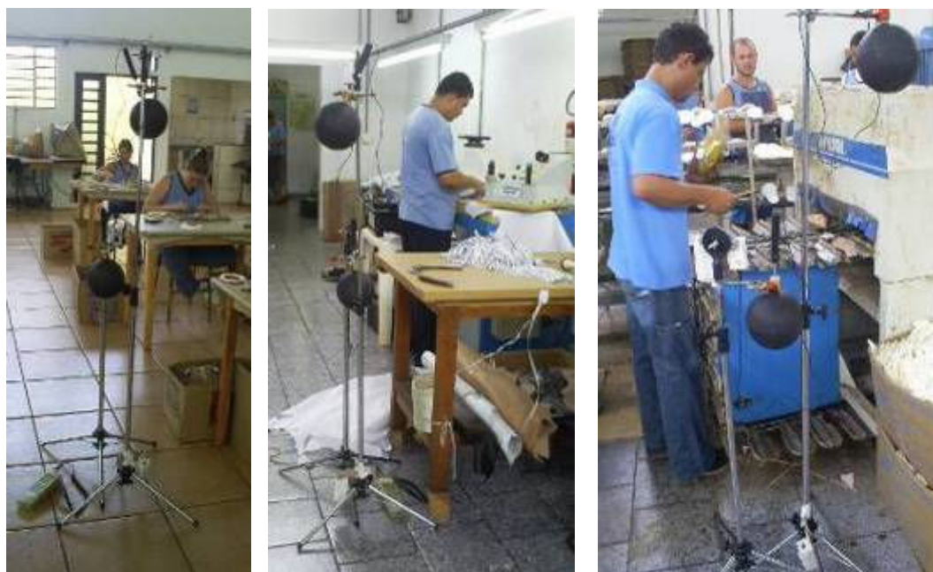
Figura 4.6.1 – Verificação de heterogeneidade das temperaturas e velocidade do ar
