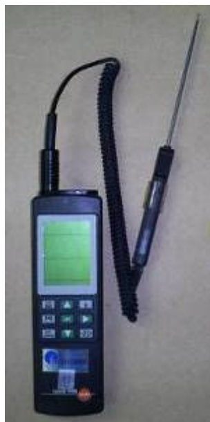
Figura 4.3.4 – Registrador multi-função Testo e sensor de esfera quente
