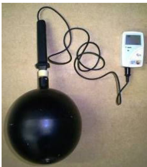
Figura 4.3.2 – Sensor de temperatura inserido no globo
