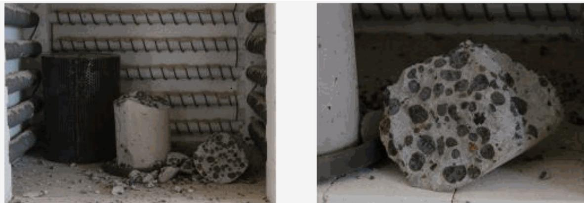
Figura 4.7 – Explosão ocorrida no concreto preparado com agregado argila expandida após aquecimento a 600°C, com teor de umidade igual ao do ambiente e taxa de aquecimento de 1°C/minuto.
