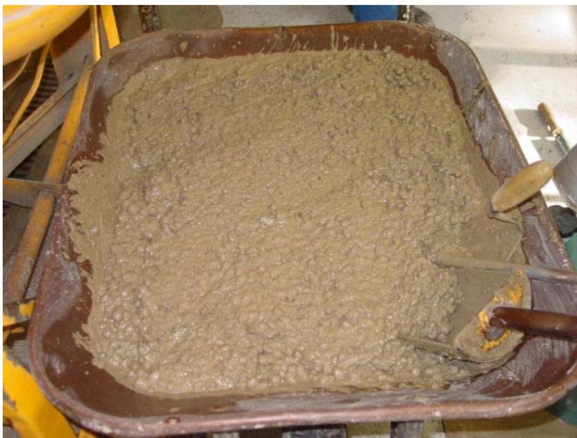
Figura 3.3 - Mistura de concreto preparada com agregado argila expandida.
