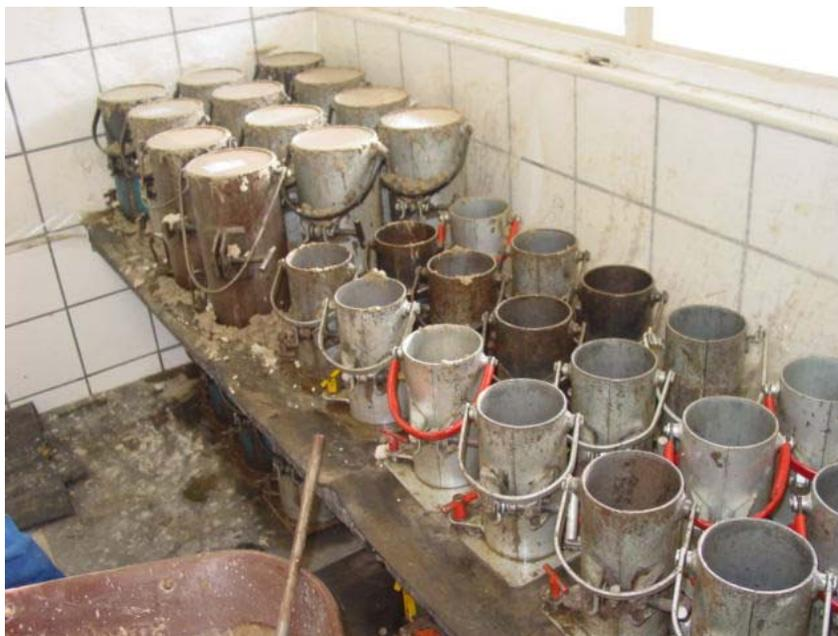
Figura 3.4 - Preparação das fôrmas para moldagem dos corpos-de-prova (Dimensão: 10 cm x 20 cm).
