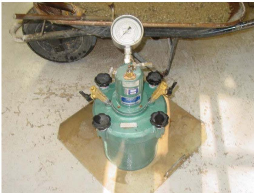
Figura 3.1 - Ensaio para determinar teor de ar incorporado, pelo método pressométrico.
