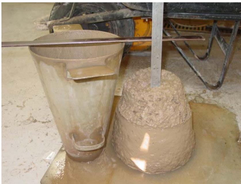
Figura 3.2 - Ensaio de “Slump Test” para determinar o abatimento do concreto preparado com agregado argila expandida.
