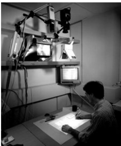
Figura 64. O sistema DigitalDesk proporcionou interação direta sobre uma projeção. Extraído de: http://www.labri.fr/perso/riviere/collection/tabletop.html , acessado em 20/09/2008.
