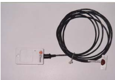
Figura 29 – Equipamento para medição da temperatura superficial
