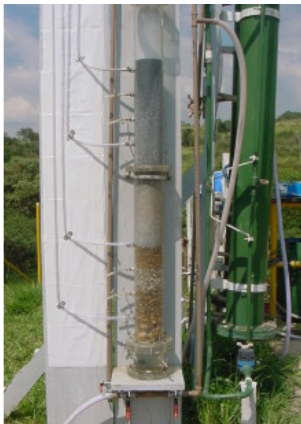
Figura 4.4 – Detalhe da segunda unidade de filtração (FRD II) instalada durante pesquisa.
