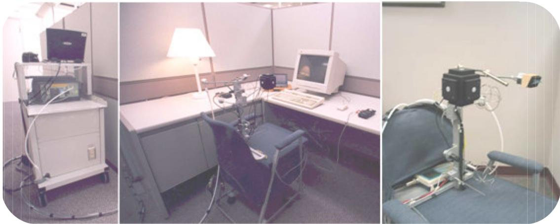
**Figura 3-10** Equipamentos usados no experimento: carrinho de apoio com cabos e sensores (esq.), estação de trabalho com cadeira especial de medição (centro) e detalhe da cadeira de medição com sensores acoplados em cubo preto (direita). (Fonte: VEITCH et al. 2005, p. 417)
