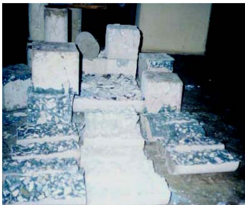
Figura 3.6 – Cilindros ensaiados à tração e cubos ensaiados à compressão.
