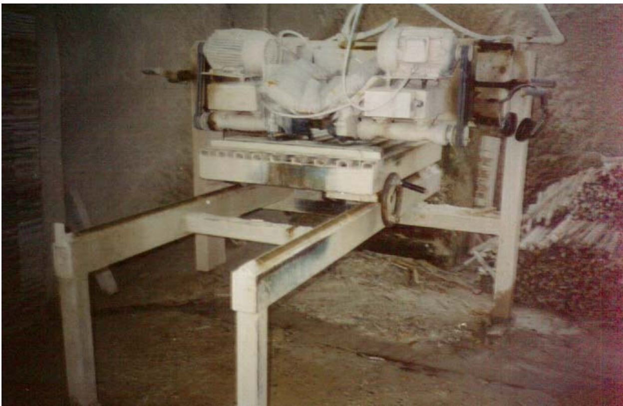
Fig. 2.7 – Máquina usada para corte da pedra mineira.
