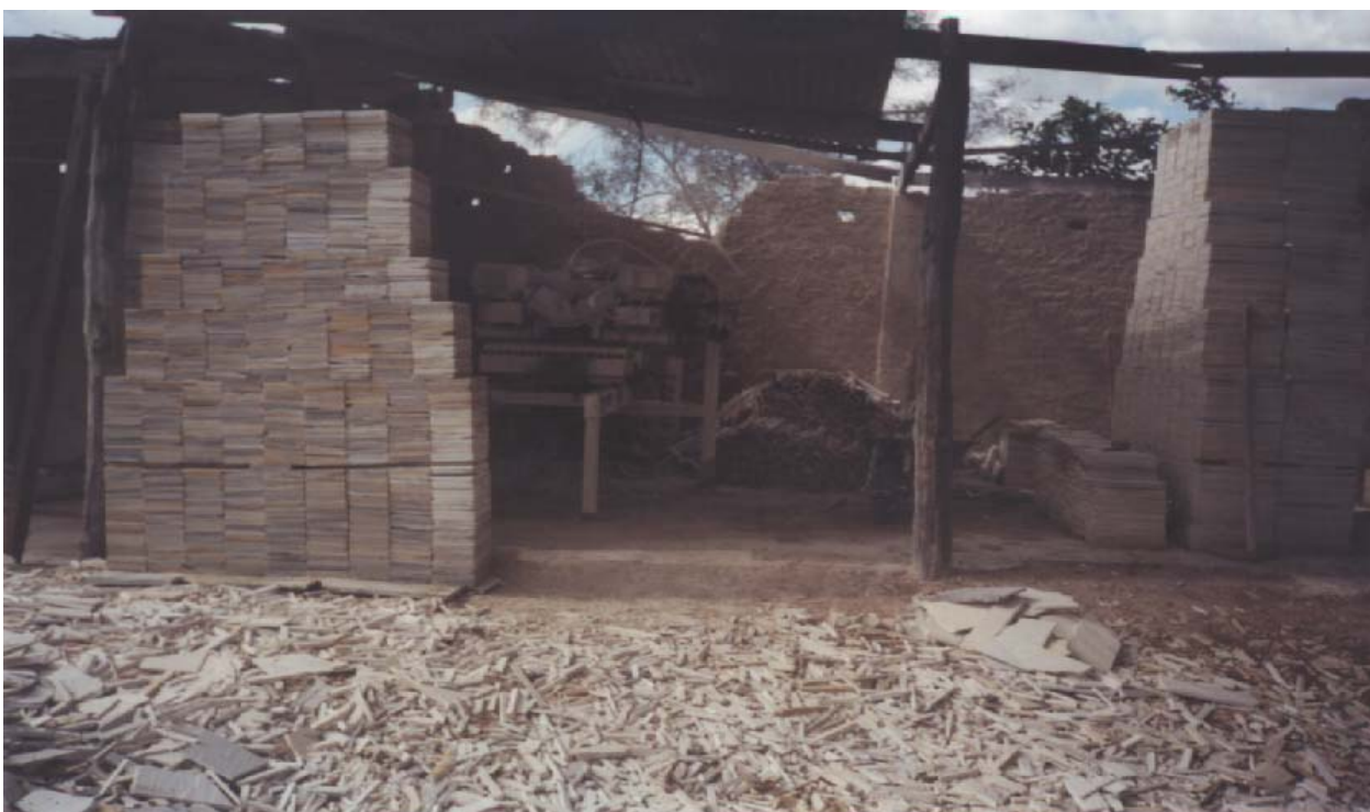
Figura 2.8 – Pedras cortadas e prontas para o comércio ao fundo; resíduos de corte à frente.
