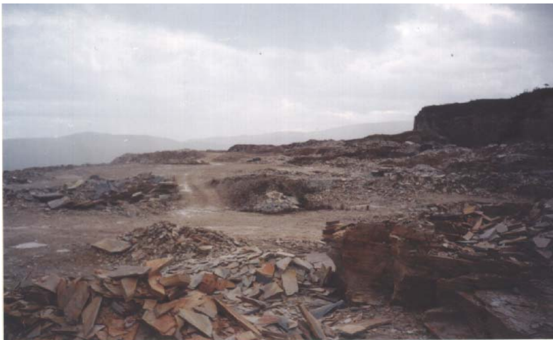
Figura 1.4 – Canteiro de extração, contendo resíduos de dimensões variando aproximadamente entre 3 cm e 30 cm.
