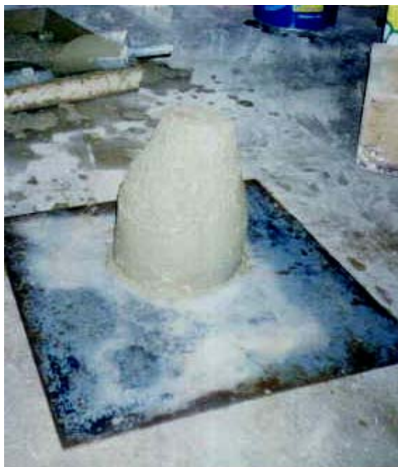
Figura 3.2 – Determinação da consistência pelo abatimento de tronco de cone.
