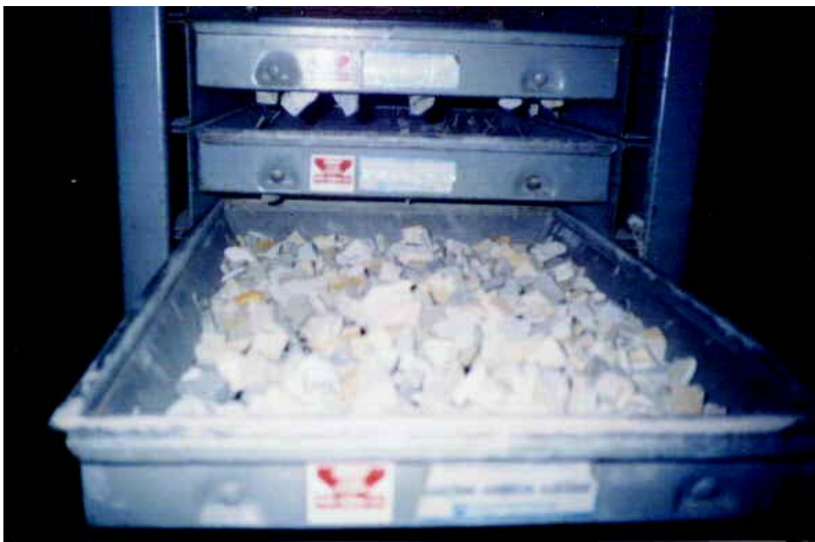
Figura 3.1 – Agregado constituído de brita 2 na respectiva peneira.
