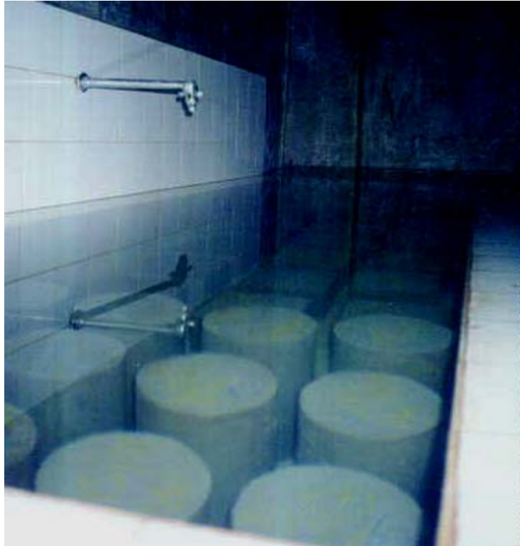
Figura 3.3 – Corpos de prova imersos em água durante a cura.
