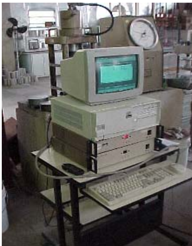
Figura 3.9 – Aquisidor de dados acoplado ao microcomputador e conectado ao corpo de prova.
