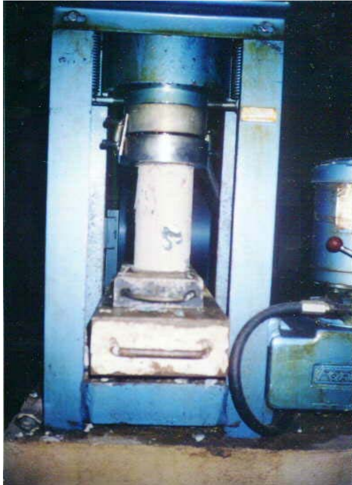
Figura 3.5 – Concreto A - Ensaio de compressão no momento da ruptura.
