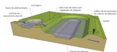
Esquema de uma Lagoa Pluvial
