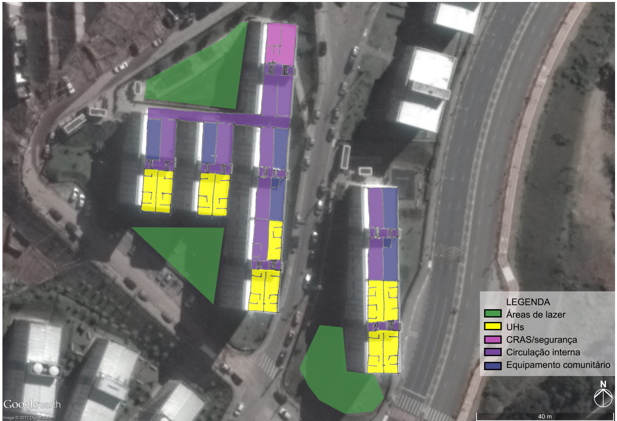
Figura 13 Esquema da implantação dos Condomínios E e G do projeto Complexo Paraisópolis, com destaque para o pavimento térreo
