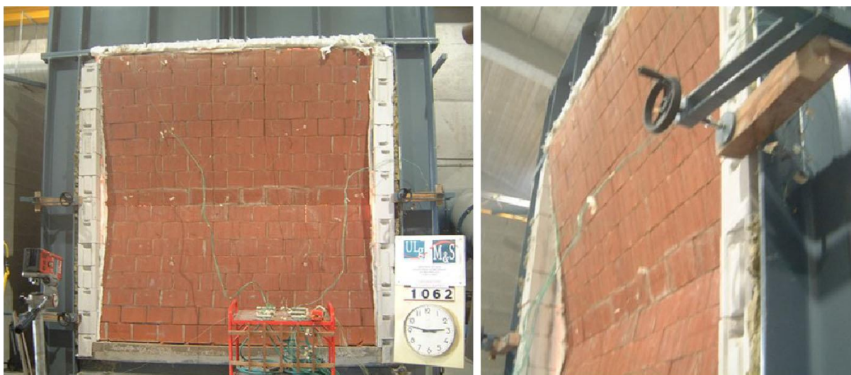
Figura 8 – Flecha de uma parede estrutural ao final do ensaio de incêndio.
