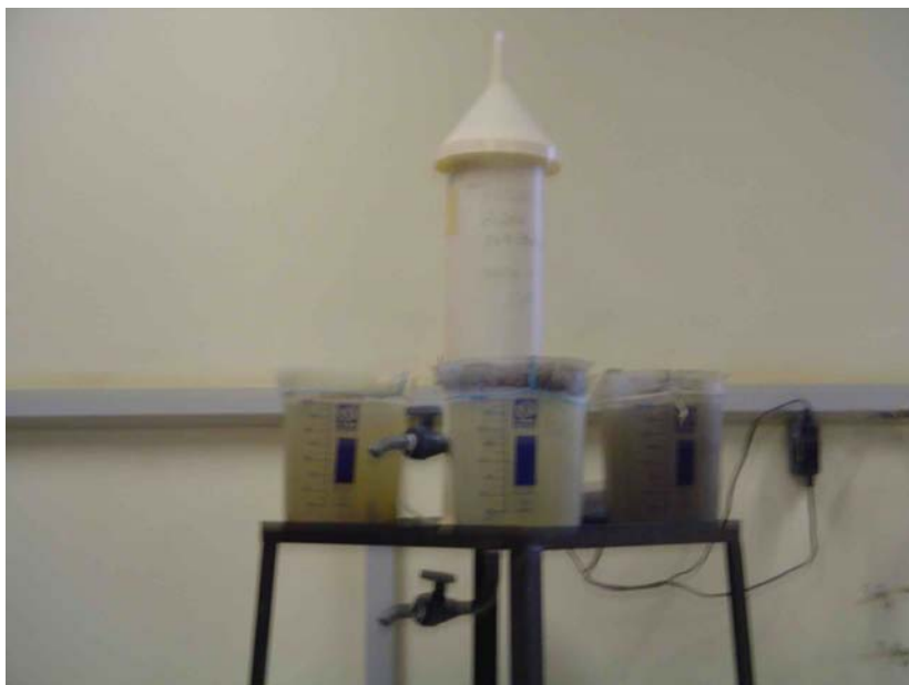
Figura 4.11: Reatores biológicos de bancada, tipo lodos ativados por batelada, utilizados para aclimação da biomassa e geração de semente aos reatores da instalação protótipo em escala real.
