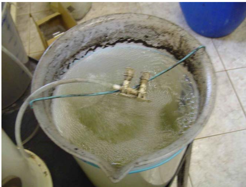
Figura 4.12: Aspecto da aeração nos reatores biológicos de bancada.
