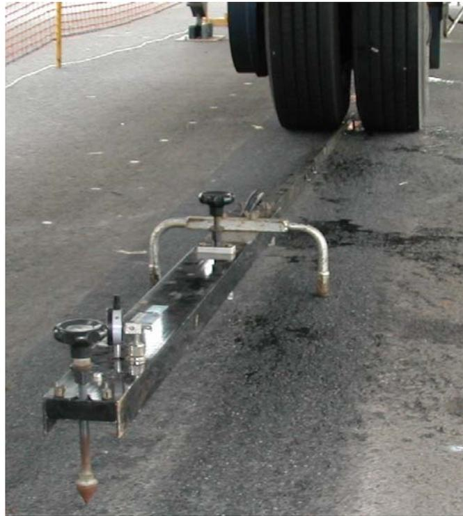
Foto 3.13 - Viga Benkelman em processo de medição
