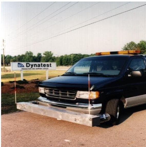
Foto 3.2 - Sensores do Perfilômetro Laser no pára-choque dianteiro
