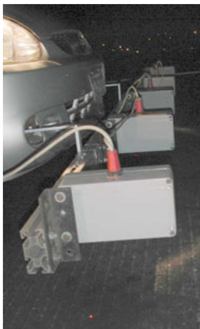
Foto 3.3 - Detalhes do Perfilômetro Laser no pára-choque dianteiro
