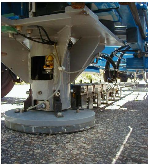
Foto 3.10 - FWD - Detalhe dos geofones - Fonte: Dynatest Engenharia (2004)
