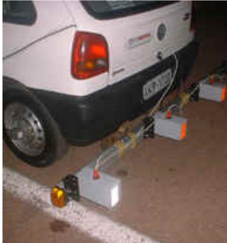
Foto 3.4 - Perfilômetro Laser no pára-choque traseiro
