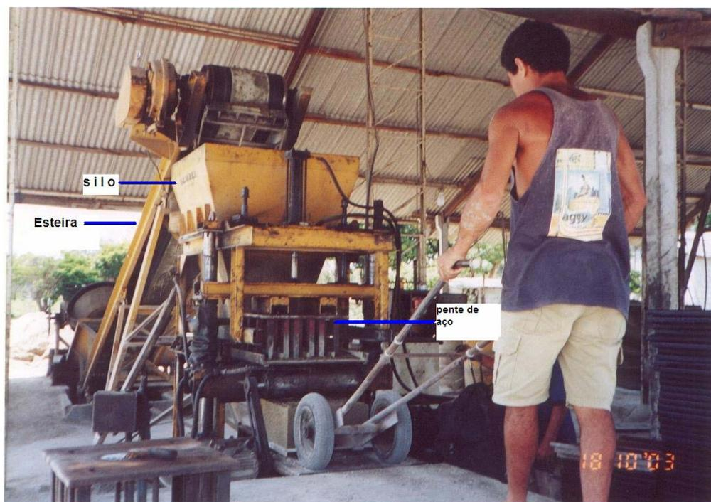
Figura 3.1 – Vibro-prensa da marca BARRAL
