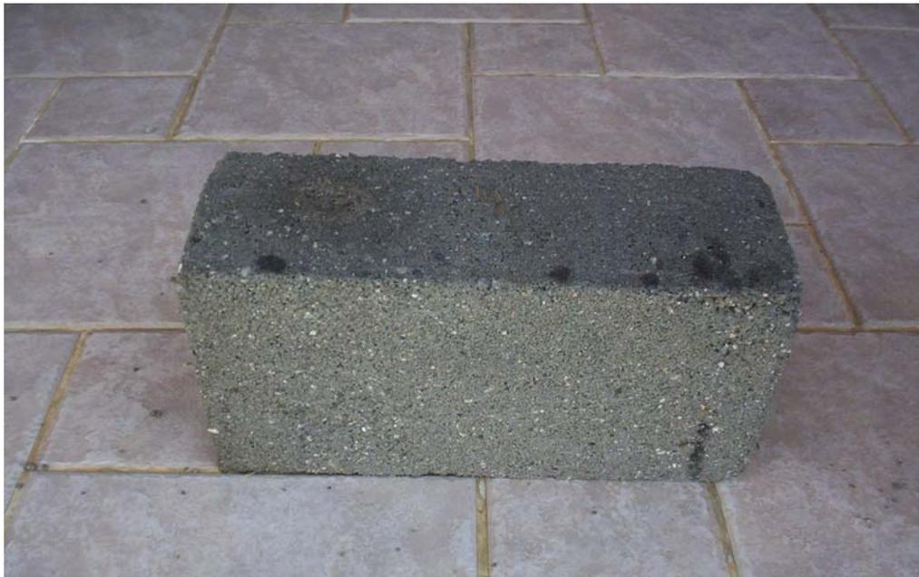
Figura 1.B – Bloco de concreto com pó de serra (Traço em massa 1:0,4)
