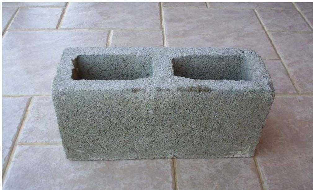
Figura 2.B – Bloco de concreto com adição de pó de serra
