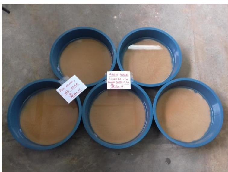
**Figura 11** – Banho de imersão da areia em 0,1 M de HCl na proporção de 2 para 5 (m/v) por 24 horas.
