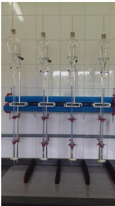
**Figura 17** – Colunas preenchidas com pedrisco e A-R à esquerda e A-N à direita.
