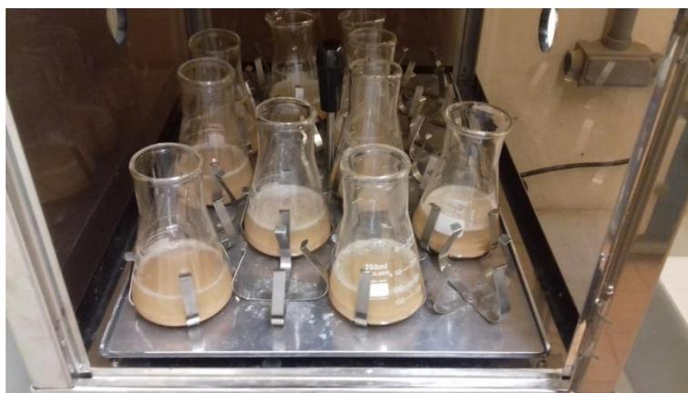
**Figura 13** – Banho de imersão da areia em solução a 2% de Fixacor na proporção de 1 para 1 (m/v) por 1 hora em mesa agitadora.
