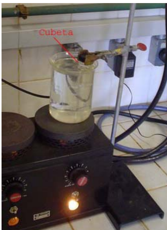
Figura 4.2: Banho quente para aquecimento da cubeta contendo a amostra
