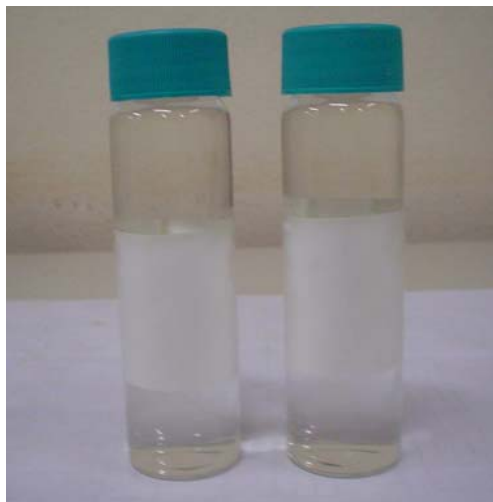
Figura 4.4: Foto dos “vials” utilizados para a coleta e preservação das amostras a serem enviadas para laboratório cromatográfico.
