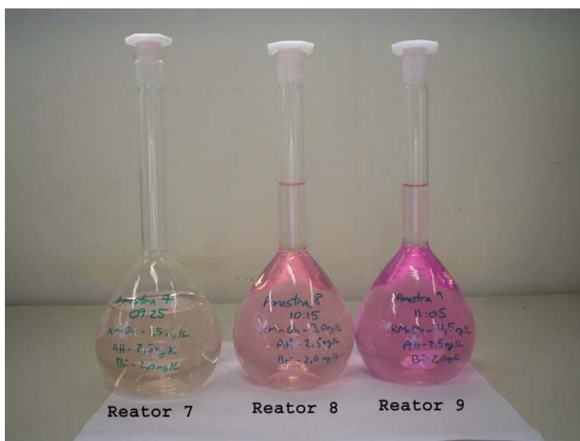
Figura 5.3: Foto dos reatores 7, 8 e 9 após tempos de reação de 2 horas, 1 hora e 10 minutos respectivamente
