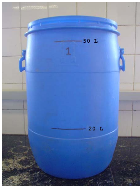
Figura 4.5: Foto da bombona utilizada para coleta e como reator de oxidação na segunda etapa da pesquisa
