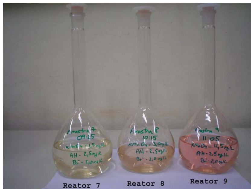
Figura 5.4: Foto dos reatores 7, 8 e 9 após tempos de reação de aproximadamente 14, 13 e 12 horas, respectivamente
