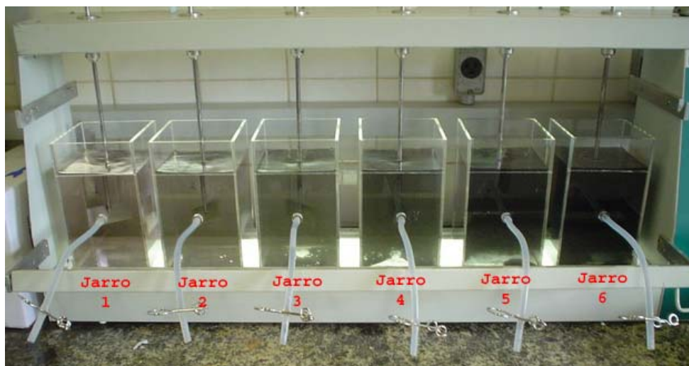
Figura 5.20: Foto dos jarros contendo as amostras oxidadas após a adição de CAP, no ensaio 25
