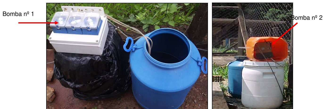
Figura 4.7: Bombas dosadoras peristálticas
