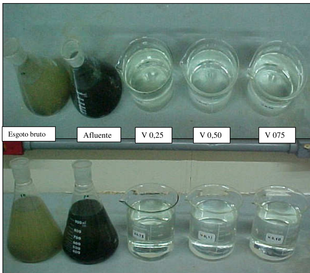
Figura 5.34: Esgoto bruto, Afluentes e efluentes das valas de filtração na 22ª semana de aplicação em vista superior e lateral
