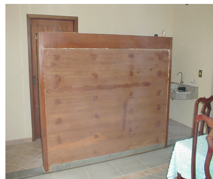
Figura 5.2: Painel de solo-cimento. Foto: André Heise, 2001
