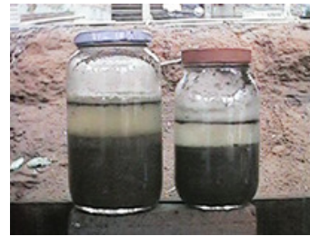
Figura 3.15: Ensaio do vidro. Foto: André Heise, 1999.
