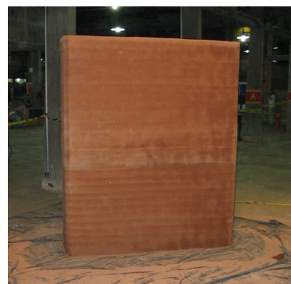
Figura 5.5: Painel de solo-cimento . Foto: André Heise, 2003
