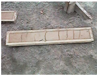
Figura 3.14: Ensaio da caixa . Foto: Márcio Hoffmann, 1999.
