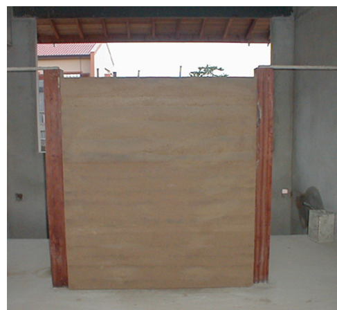
Figura 5.3: Painel de solo-cimento . Foto: André Heise, 2003.
