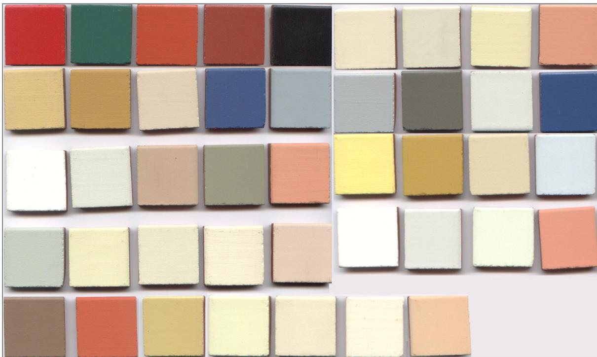
**FIGURA 5.1:** Amostras pintadas com tintas do tipo Acrílica e PVA produzidas pela Sherwin Williams.
