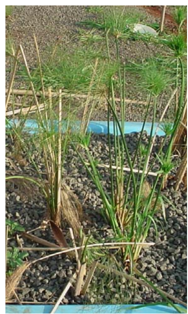
Figura 6.4 – Evolução da vegetação no wetland -construído com leito de bambu e vegetado com papiro – tanque 4
