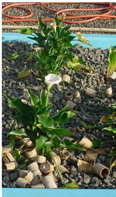
Figura 6.3 – Evolução da vegetação no wetland -construído com leito de bambu e vegetado com plantas mistas – tanque 3
