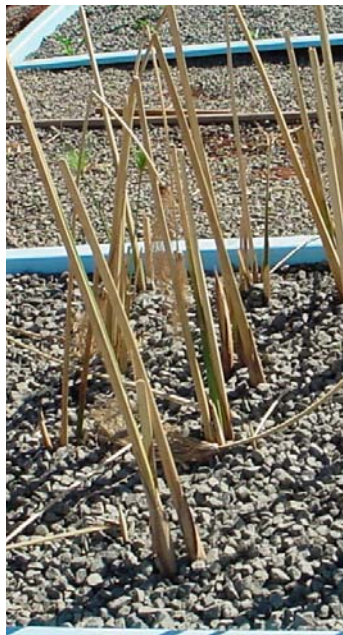
Figura 6.4 – Evolução da vegetação no wetland -construído com leito de bambu e vegetado com papiro – tanque 4
