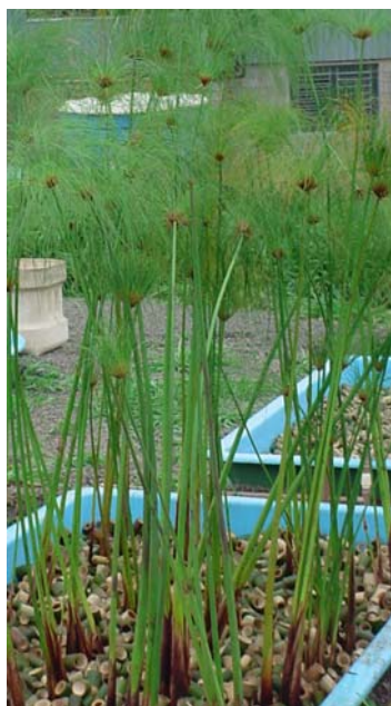
Figura 6.4 – Evolução da vegetação no wetland -construído com leito de bambu e vegetado com papiro – tanque 4
