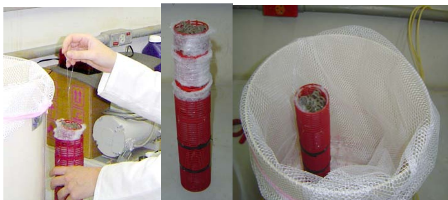
Figura 4.4. Cestos para coleta de anéis de Raschig ao longo do reator.
