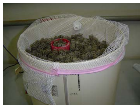
Figura 4.3. (a) Pontas porosas no fundo do reator; (b) reator preenchido com os anéis de Raschig.
