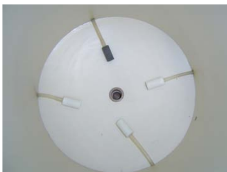
Figura 4.3. (a) Pontas porosas no fundo do reator; (b) reator preenchido com os anéis de Raschig.
