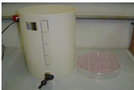
Figura 4.2. (a) Barrilete e fundo falso; (b) reator montado com o fundo falso.
