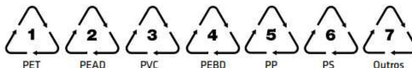
Figura 13 – Identificação de materiais plásticos conforme NBR 16182 e 13230
