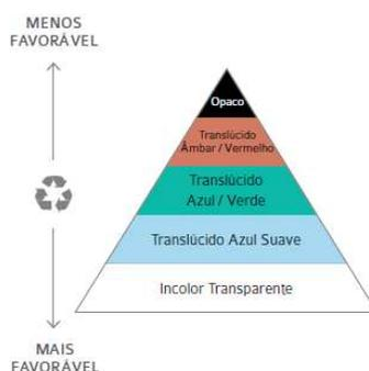
Figura 14 – Interferência da coloração na reciclagem dos materiais plásticos
