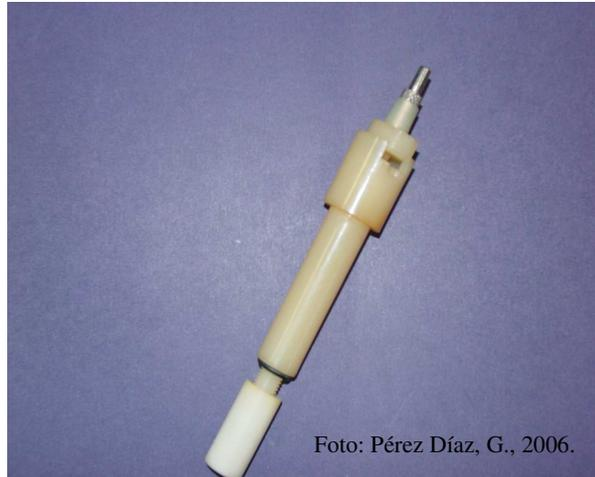
Figura 5.2 – Separador de partículas ciclone de nylon Dorr-Oliver de 10 mm
