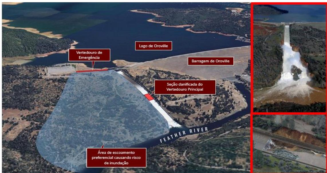
**Figura 22.** Barragem de Oroville e falha no vertedouro principal (Adaptado de CRISIS, 2017).
