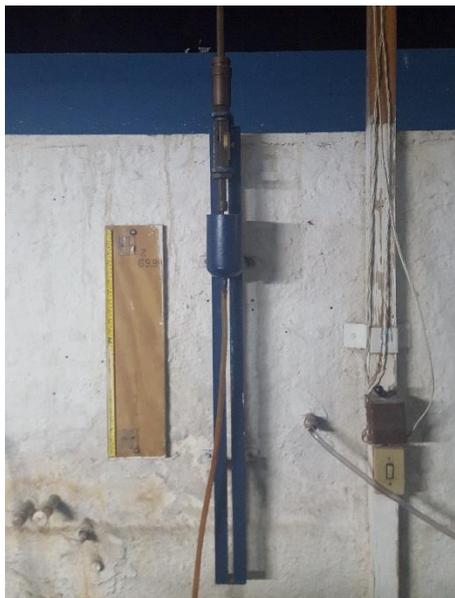
Figura 70. Sistema de medição de nível d'água. Fonte: CTH
