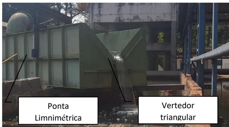
Figura 71. Vertedor triangular similar ao utilizado no modelo físico. Fonte: CTH
