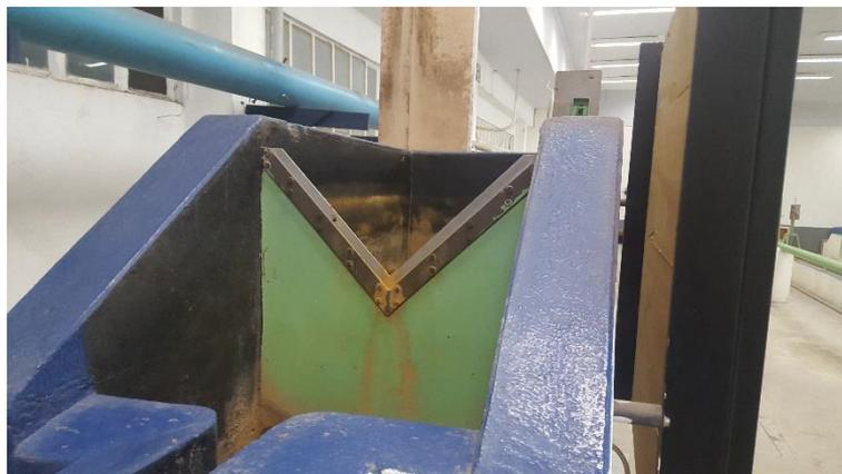
Figura 63. Vertedor triangular similar ao modelo físico da barragem em gabiões Fonte: CTH
