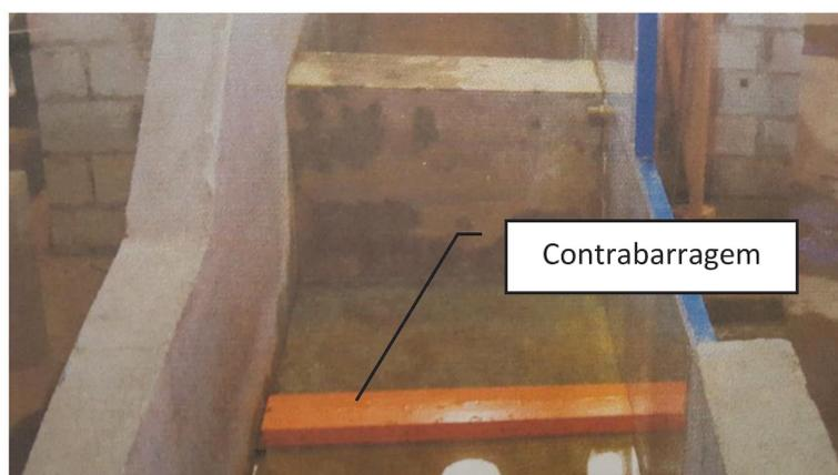
Figura 67. Contrabarragem localizada a jusante da bacia de dissipação. Fonte: CTH
