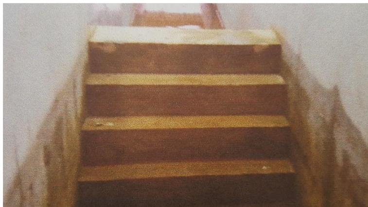
Figura 65. Barragem com  $P=4\text{m}$ , modelo físico reduzido Fonte: CTH
