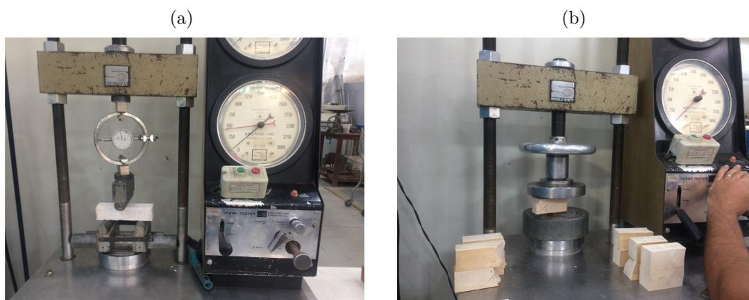
Com o objetivo de garantir que as amostras estivessem com umidade próxima, aproximadamente 24h antes dos ensaios cada corpo de prova foi colocado dentro de um dessecador até o momento do ensaio. No ensaio de resistência à flexão ( $R_f$ ) utilizou-se 3 corpos de prova e para o ensaio de compressão usou-se as metades dos 3 corpos de prova do ensaio de flexão.
