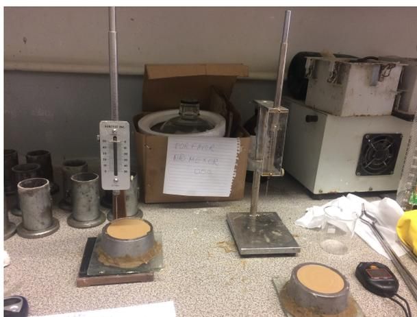
Dessa maneira são feitas diversas medições da distância entre o fundo do molde e a agulha. Os resultados das penetrações são anotados e determina-se o tempo de início e fim de pega por interpolação.
