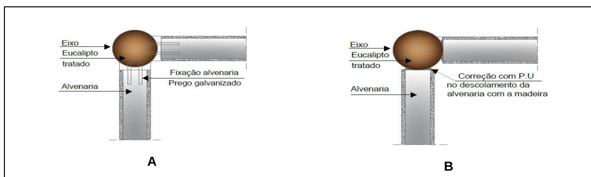
A: Detalhes de fixação entre pilar/alvenaria; B: Correção de descolamento com PU. Fonte: Elaborada pela autora, 2020.
