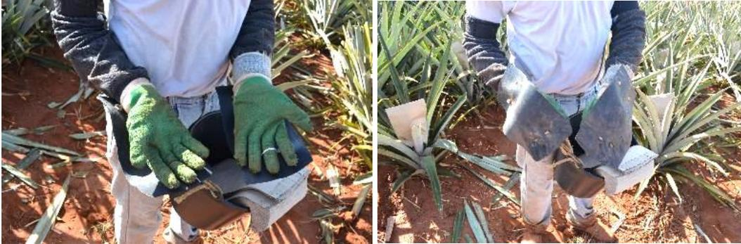
Conforme pode ser observado na figura 172 foi criado um acessório com câmara de pneu para ser acoplado à luva de borracha e fixado por um cordão amarrado de forma a reforçar a proteção do dorso da mão quando a mesma for inserida no meio das folhas serrilhadas e espinhos.
