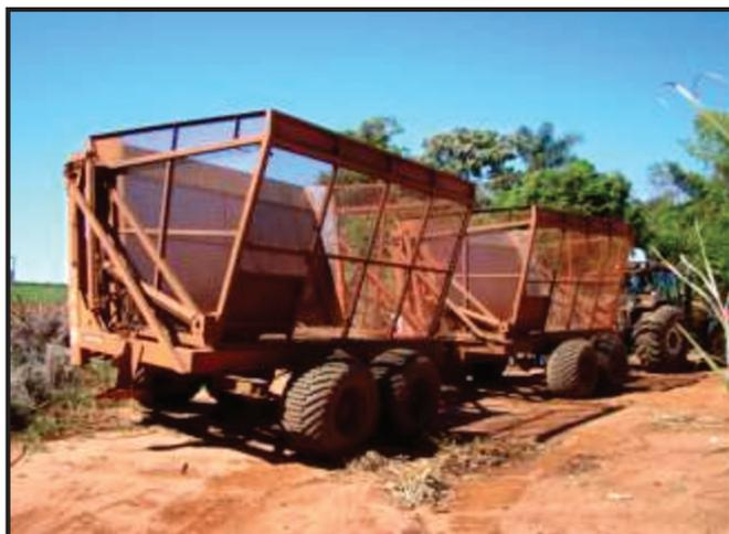
Figura 9. Transbordo da linha de implementos ANTONIOSI modelo 8000D, utilizado para o transporte da cana-de-açúcar após a colheita.
