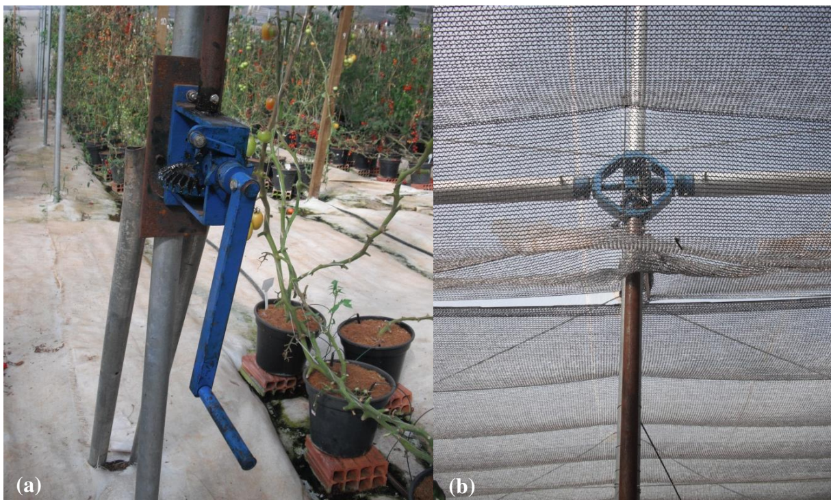
Figura 4: Detalhes da manivela (a) e barras de sustentação (b) do sistema retrátil de abertura/fechamento da tela termorrefletora.
