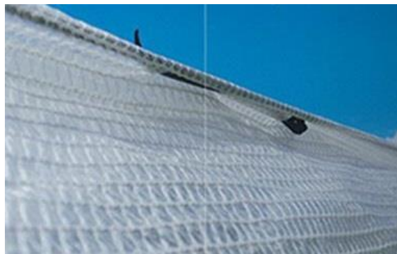
Figura 2: Filme plástico de PEBD reforçado (Foto: SOL PACK, 2013).
