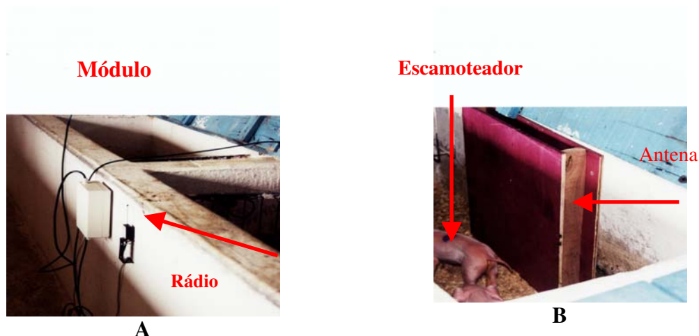
Figura 21 - Rádio localizado na parede do escamoteador (A), Leitor fixo com a caixa de madeirite localizada dentro do escamoteador (B).
