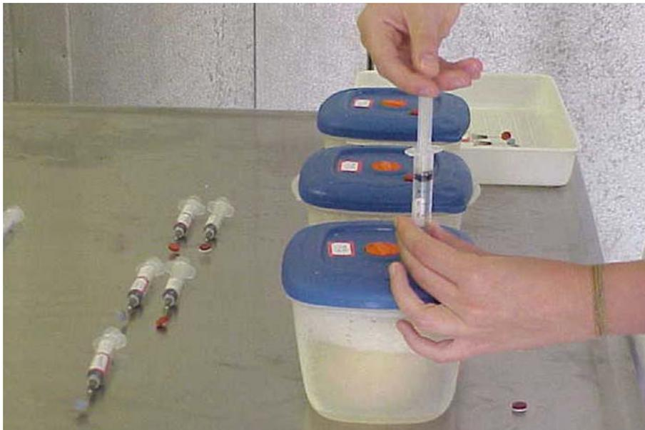
FIGURA 18. Retirada de amostras gasosas
