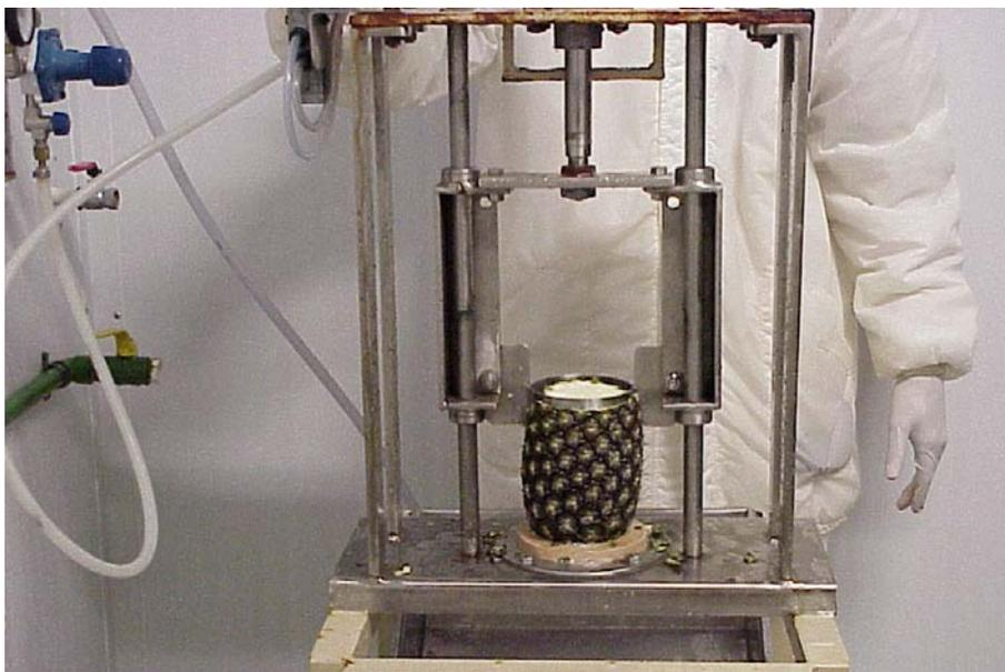
FIGURA 8. Descascamento mecânico
