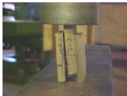
Figura 34 - Corpo-de-prova *B. vulgaris*, tratamento químico com adesivo Cascophen
