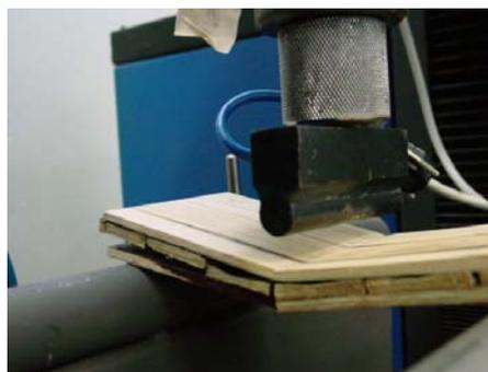
Figura 50 - Contraplacado *B. giganteus* com adesivo Cascamite
