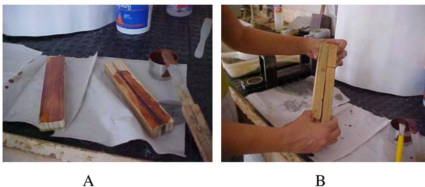
Figura 21 - Blocos colados individualmente e colagem de dois blocos
