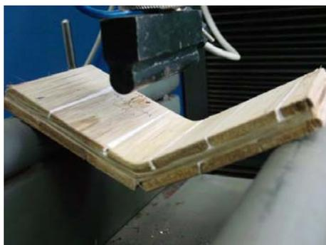
Figura 49 - Contraplacado *B. giganteus* com adesivo Cascophen
