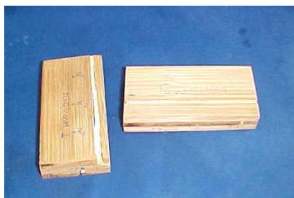
Figura 31 - Contraplacado (CPB) com adesivo Cascamite, após saturação em água e secagem em estufa
