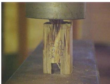
Figura 33 - Corpo-de-prova *D. giganteus*, tratamento água com adesivo Cascamite
