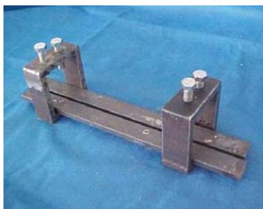
Figura 15 - Dispositivo para a prensagem das lâminas
