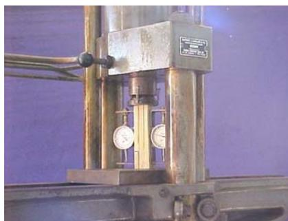
Figura 23 - Corpo-de-prova na máquina de ensaio, com relógios comparadores
